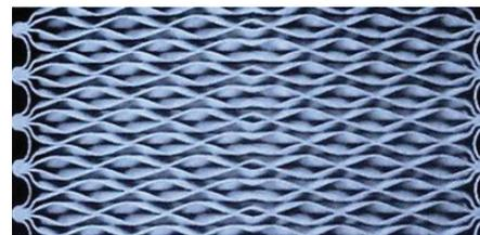
Querschnitt eines Plattenpakets
