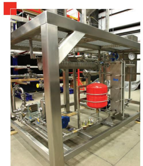
Als Teil der Konstruktion verlangte Dare Foods Dreiwege-Verteilventile, um die Anlage während eines Stromausfalls zu schützen. API hat die Anlage so konstruiert, dass sie mehrere dieser Ventile enthält, die sich bei einem Stromausfall öffnen. Wenn sich die Ventile öffnen, fällt der gesamte Zucker auf den Boden und schützt so die Ausrüstung.
